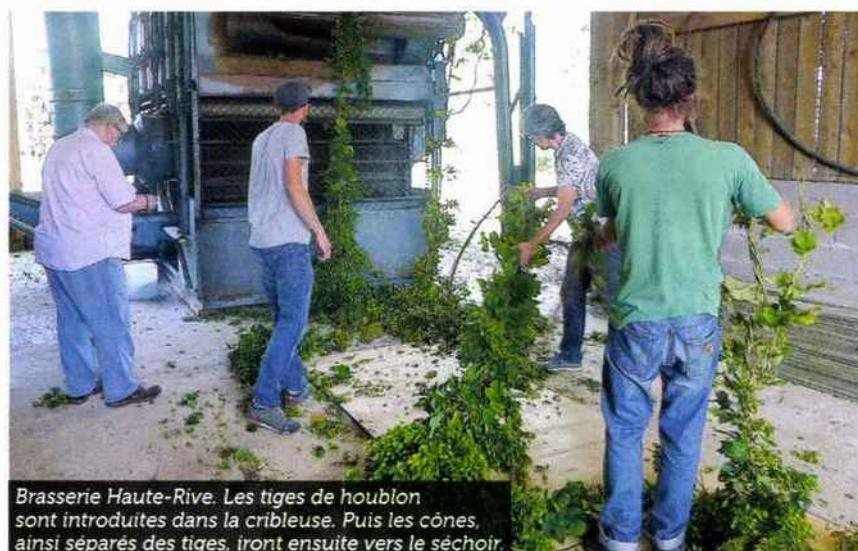
Brasserie Haute-Rive. Les tiges de houblon sont introduites dans la cribreuse. Puis les cônes, ainsi séparés des tiges, iront ensuite vers le séchoir.
