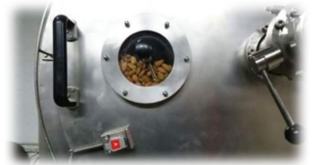
FCD System : Torréfacteur batch tout électrique qui combine conduction et convection de chaleur.
